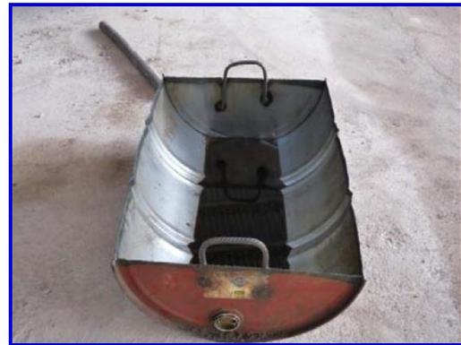
Figura 43. Contenedores para captar el hidrocarburo
